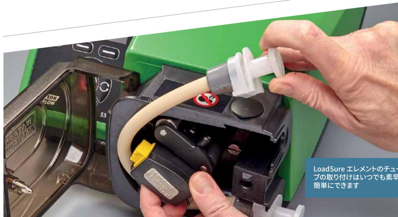
LoadSure ELEMENTのチューブの取り付けはいつでも素早く簡単にできます
