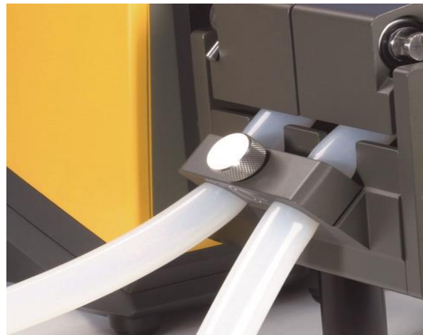
② 連続チューブを2本使用する場合 (パラレル方式) ・2本とも同内径のチューブを必ず使用して下さい。
